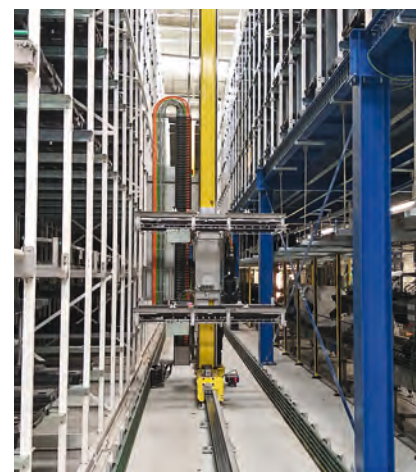
Obr. 1: Regálový zakladač s dvojitým teleskopem
